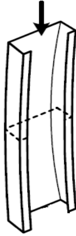
الشكل (6-2) التحنيد الكلي للعمود المعرض للضغط [Eurocode3: 2006]
